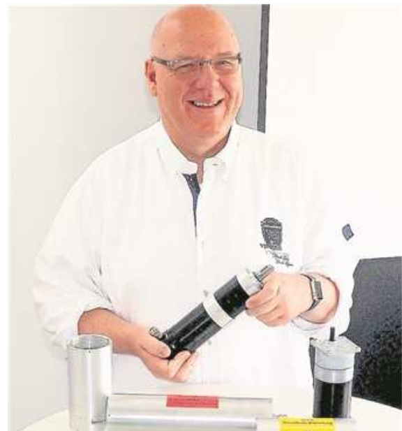
Thomas Graudenz hält einen Astro-Synchronmotor in Händen. Davon sind einige der von seiner Firma neuentwickelten druckfesten und ATEX zertifizierten Kapselungen zu sehen, mit der die Motoren einen Explosionsschutz erhalten. FOTO: STEHN
